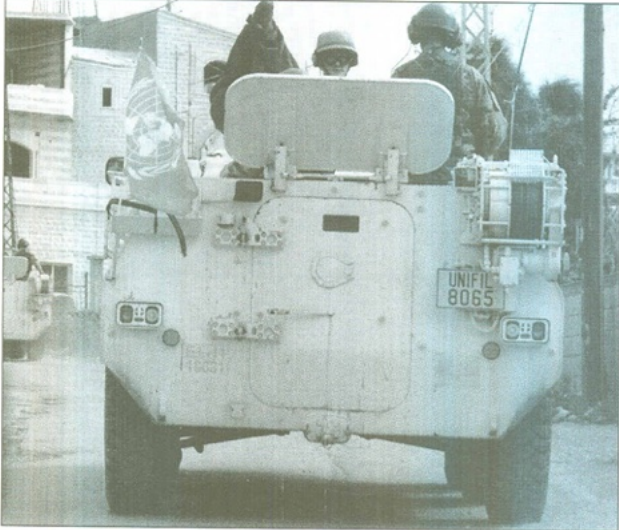
De achterzijde van de Puma 6x6. Let op de lier rechts naast de deur.
